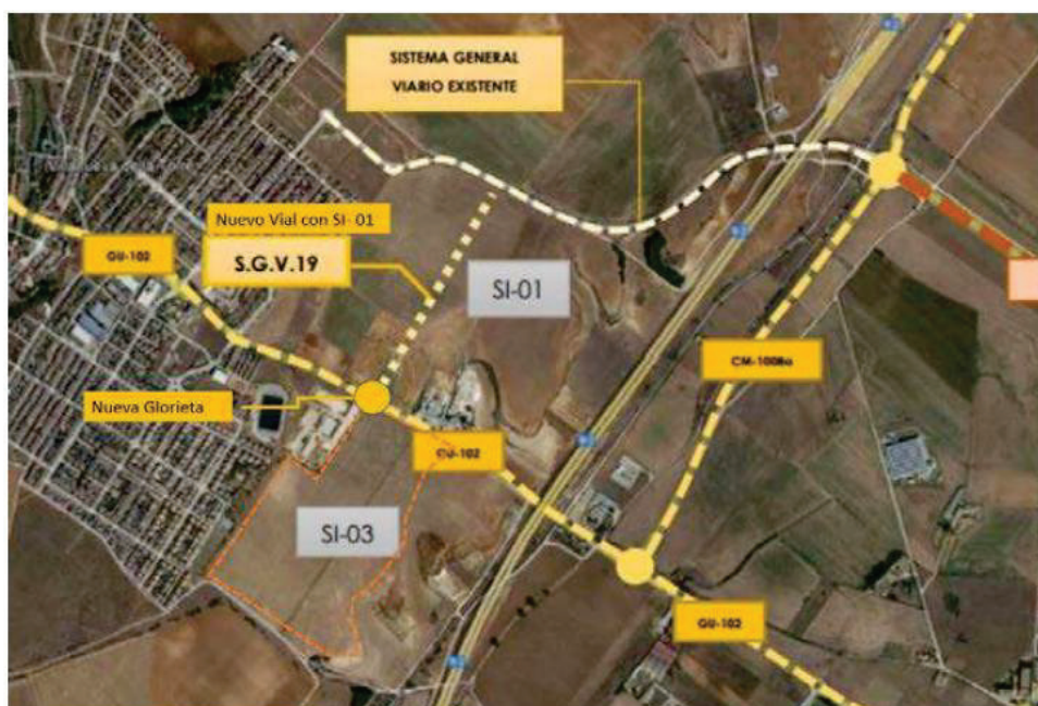
Imagen 02. Esquema de infraestructuras y conexiones viarias (pág. 247).
