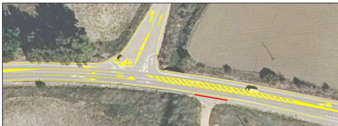
Cierre temporal del acceso mediante barrera new Jersey
