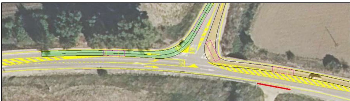
Comprobación de trayectorias de giro para vehículo patrón
