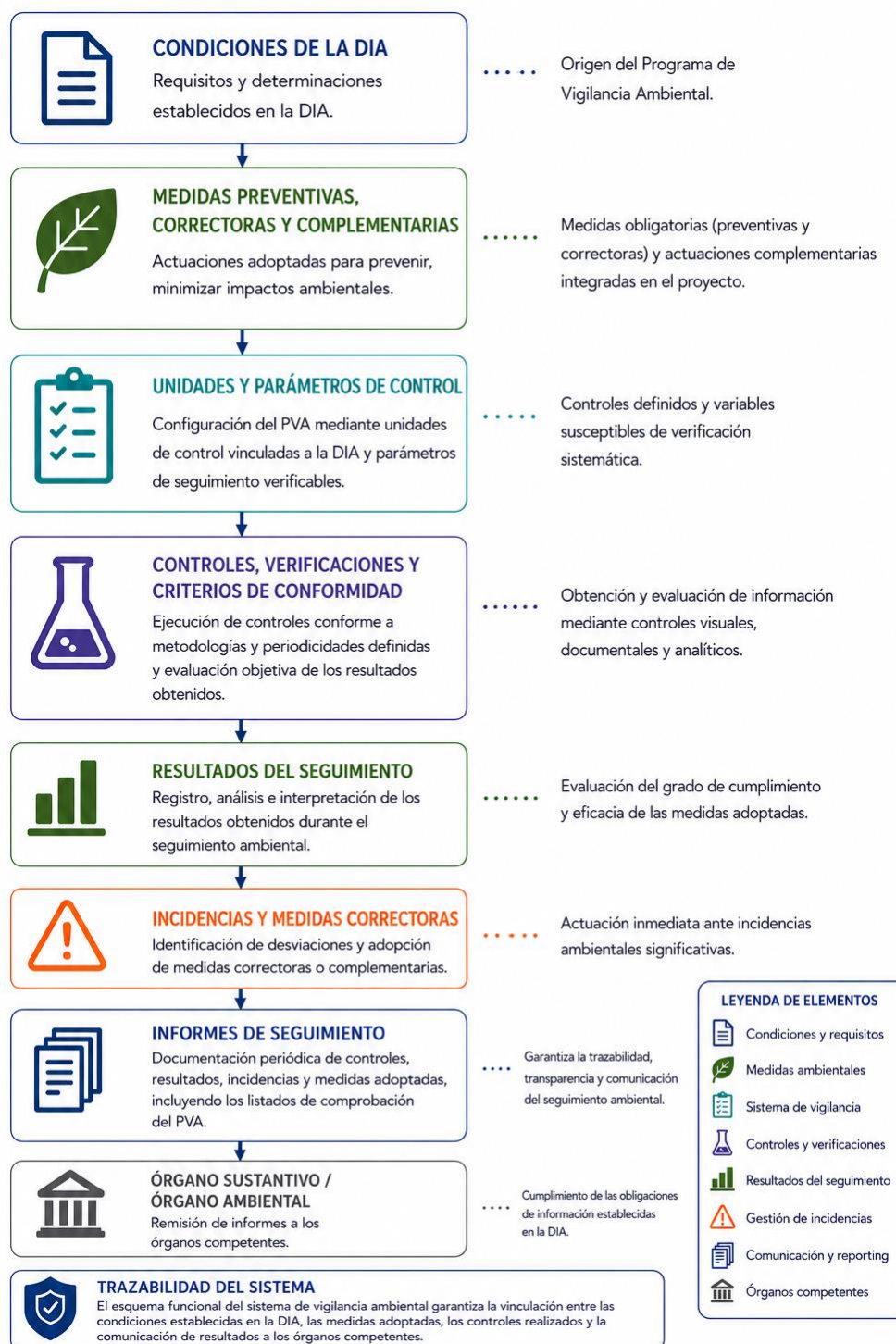
Figura 2. Esquema funcional del sistema de vigilancia ambiental.
