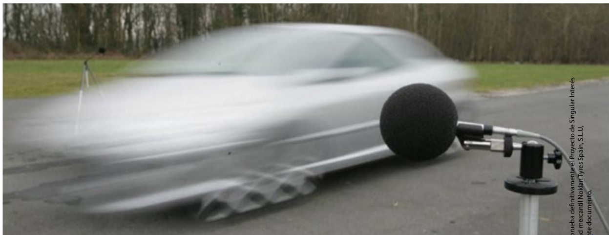
Prueba de ruidos neumático – pavimento. Pista pass by noise
