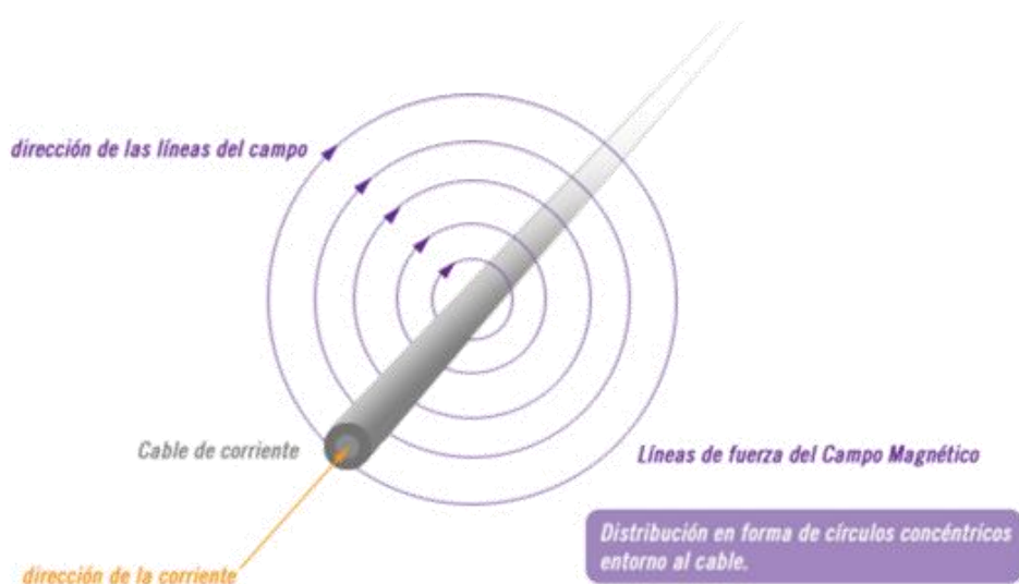
Líneas de fuerza del campo magnético en un cable de corriente
