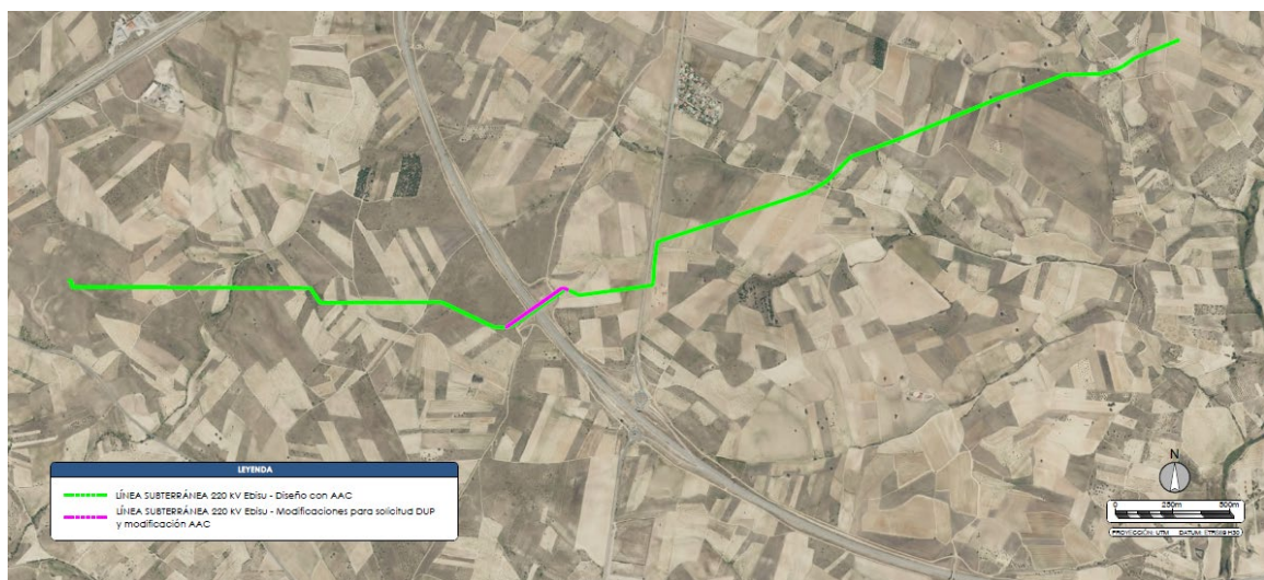
Figura 2 Vista de detalle en ortofoto de las modificaciones realizadas en el diseño de la línea de evacuación «Línea subterránea 220 kV Ebisu» presentado a solicitud de modificación de AAC, con respecto al diseño que obtuvo la AAC.
